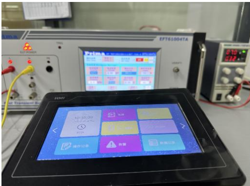
图 7-4 群脉冲测试图
